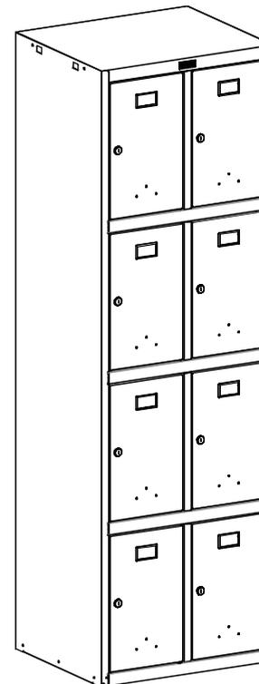
Конструкция шкафа предусматривает сборку или на саморезах, или на заклепках. В случае сбора на заклепках, они устанавливаются вместо саморезов, а также дополнительно в местах, указанных на рисунках.
