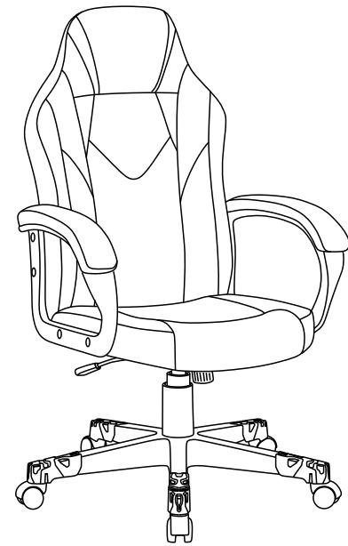
Примечание: Шаг 1. Снять защитный колпачок с газлифта, в случае его наличия. Шаг 4 - 5. Вставить и закрутить винты поочерёдно, не затягивая их до конца. После выполнения шага 5 закрутить все винты до полной фиксации. Молния чехла спинки используется исключительно в процессе производства. Попытка снять чехол самостоятельно может привести к поломке.
