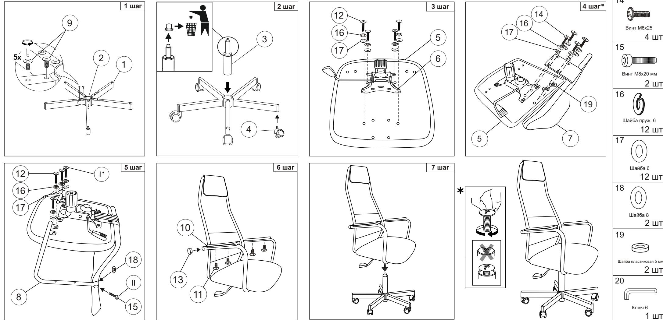
**Примечание:** Шаг 2. Снять защитный колпачок с газлифта, в случае его наличия. Шаг 4. Подложить пластиковые шайбы (деталь №19, 2 шт.) под опору спинки (под отверстия ближе к спинке), закрутить винты №14, не затянув их до конца.
