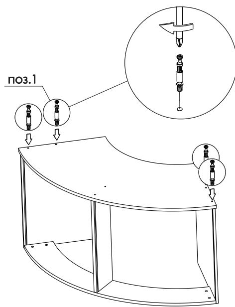
Инструкция по сборке: Приёмная стойка ПСУ-70
